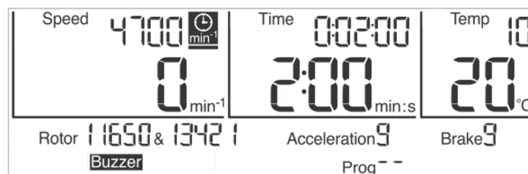
Abb. 13: Die Funktion "Laufzeit ab Solldrehzahl" ist aktiviert
