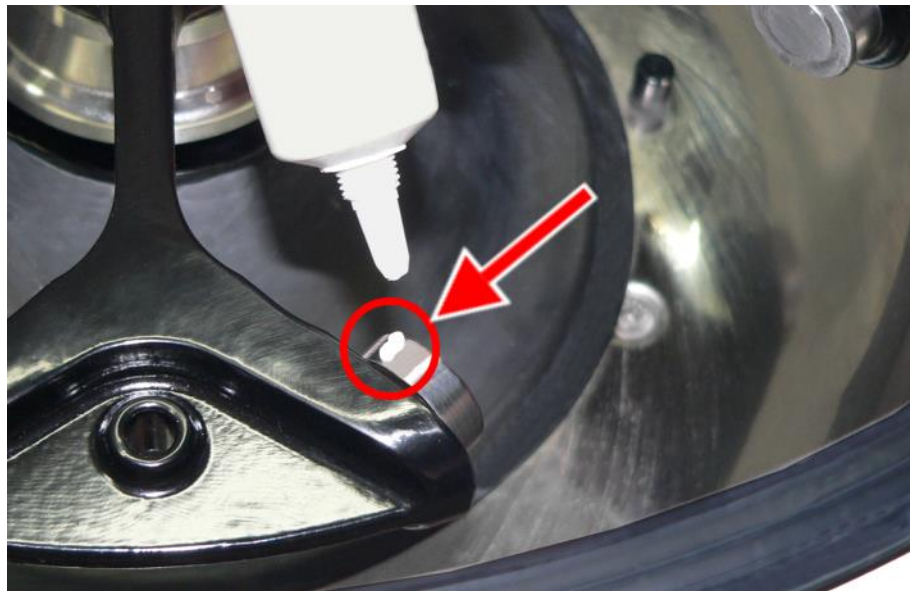
Abb. 29: ausreichende Menge Tragbolzenfett für einen Bolzen
