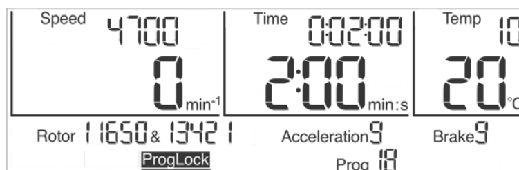
Abb. 22: Die Programmsperre "ProgLock" ist aktiviert
