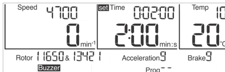
Abb. 12: Einstellen der Laufzeit, hier in der Zeiteinheit "min:s"
