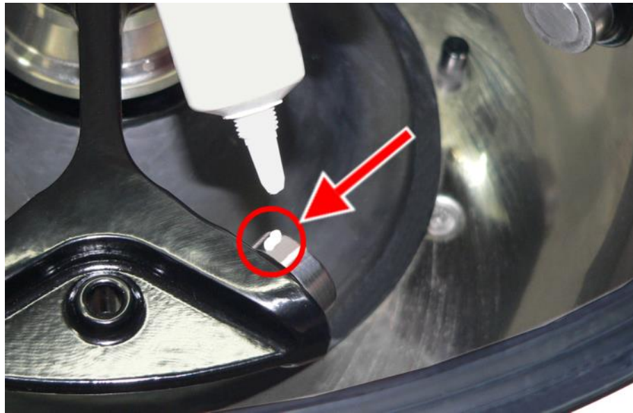
Abb. 32: ausreichende Menge Tragbolzenfett für einen Bolzen
