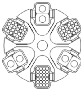
Abb. 8: Zulässige und unzulässige Beladung des Ausschwingrotors mit unterschiedlichen Gläsergrößen (Beispiele)
