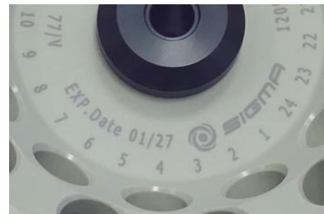
Abb. 4: abweichende Lebensdauer – Gravur auf dem Becher / Rotor
